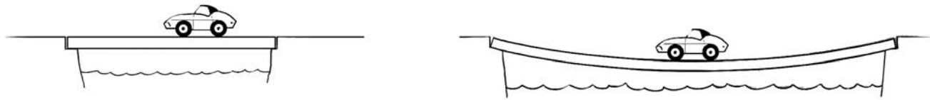
Abbildung 32 - Lange Balken sind schwächer als kurze.
