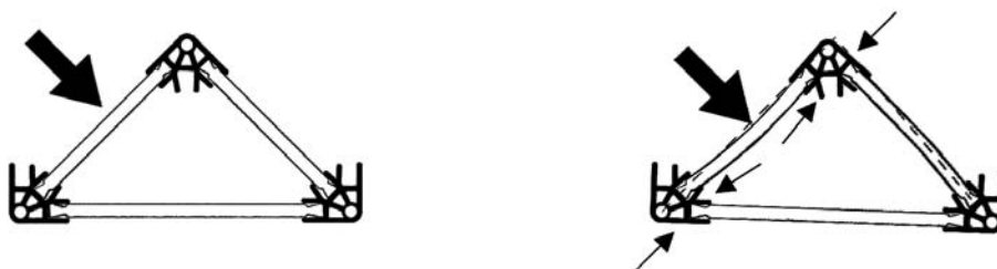
Abbildung 26 - Kraft wirkt auf die Seite eines Dreiecks.
