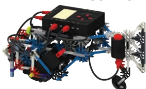
SUIVEUR DE LIGNE
